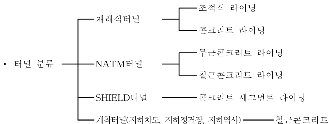
<그림 4.1> 상태평가를 위한 라이닝 시공방법에 따른 터널의 기본시설 분류
